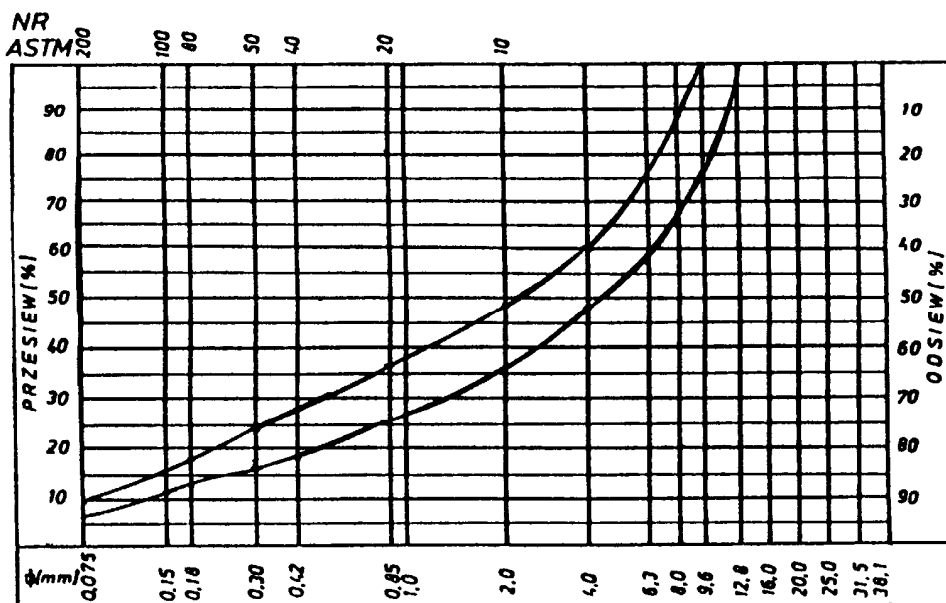
Rys. 6. Krzywe graniczne uziarnienia mieszanki mineralnej 0+16 mm do warstwy ściernalnej z betonu asfaltowego dla KR 3-6
